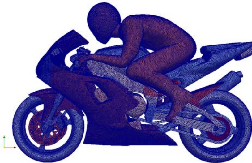
Figura D.3: Malla superficial del caso práctico motorBike en OpenFOAM
