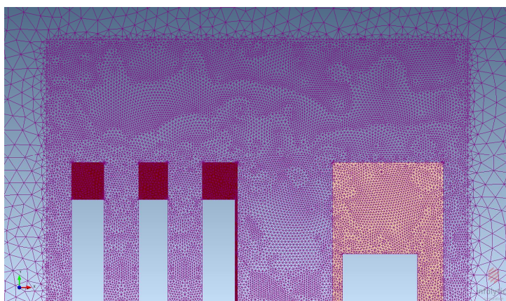
fig. 36 – mallado en el extremo de los arrollamientos
