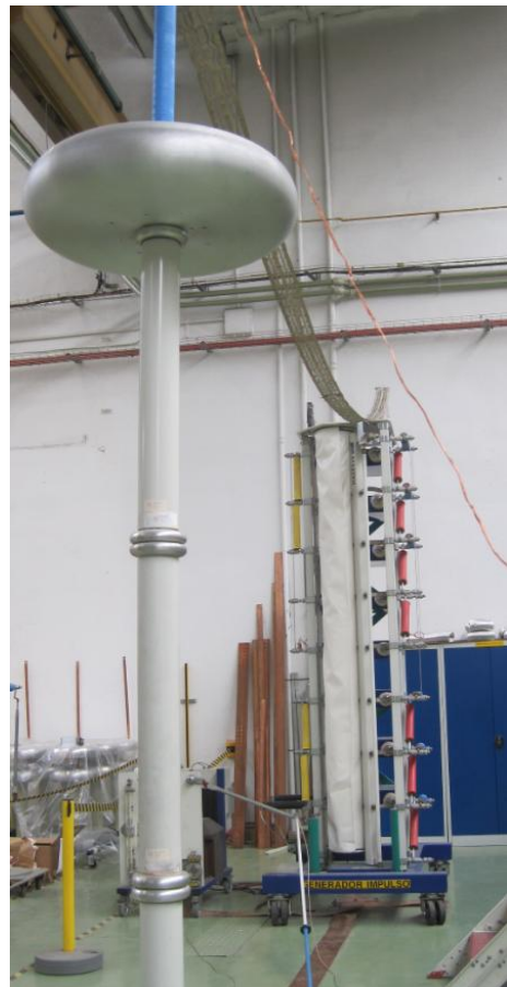
fig. 62 – esquema de un generador de impulso de AT de 4 etapas (izda.) y generador de 800 kV (dcha.)
