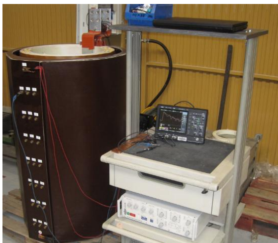
fig. 22 – medida con el generador Haefely en el AT (izda.) y generador empleado en la BT (dcha.)
