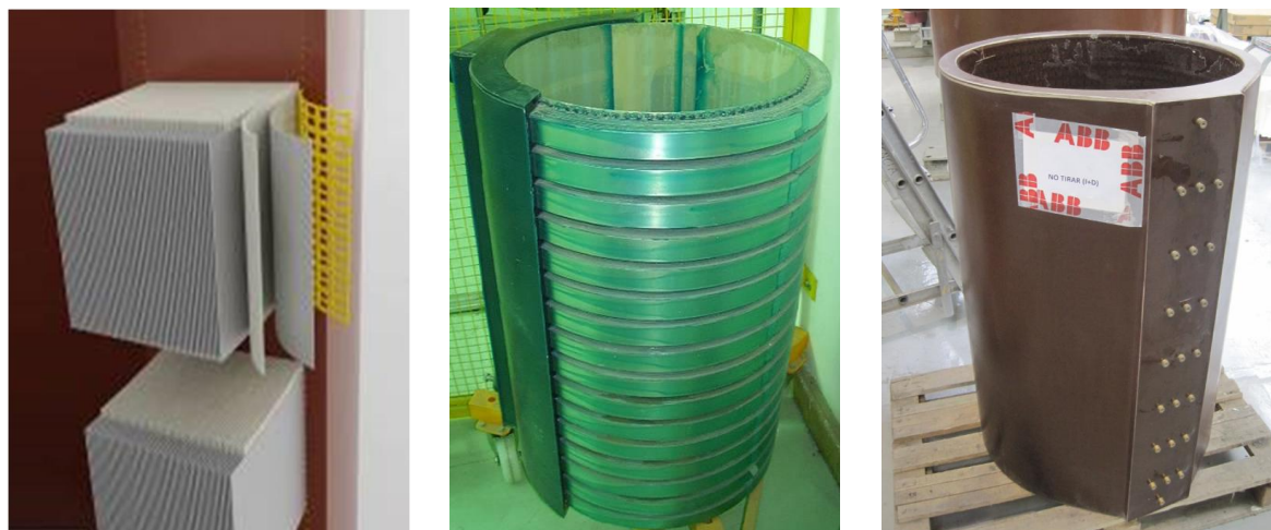
fig. 13 – estructura de un disco (izda.), estructura de un arrollamiento sin encapsular completamente (centro) y arrollamiento empleado en los ensayos (dcha.)
