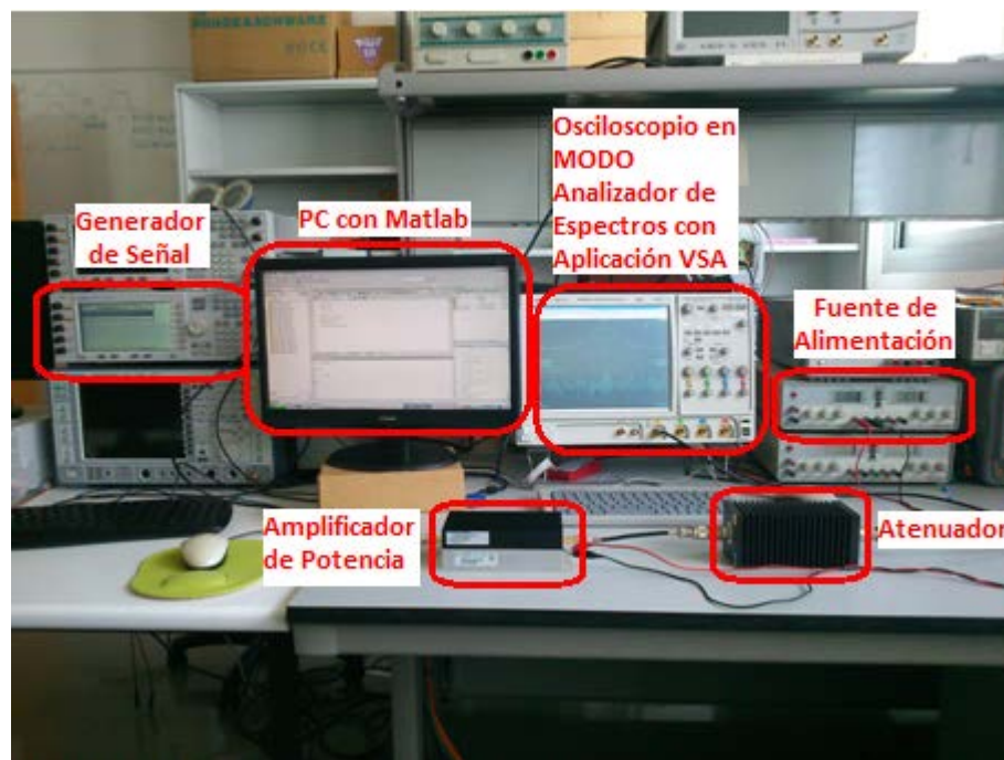
Figura D.2: Montaje experimental para la captura de señales con el osciloscopio en modo analizador de espectros.
