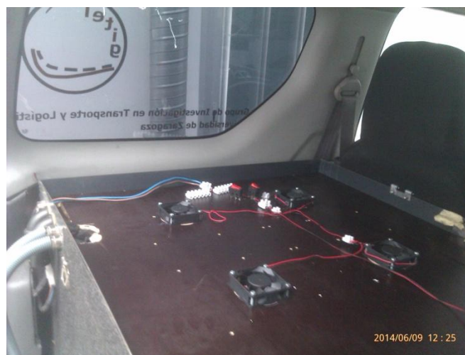
Figura 5.7: Sistema de refrigeración instalado en el cofre nº 3
