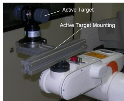
Figura 4.19. Montaje del reflector. Origen: propio.
