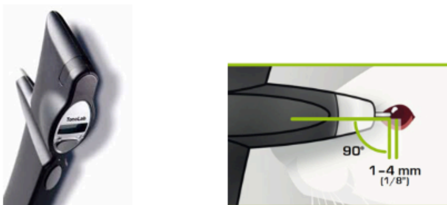
Ilustración 10: Tonómetro Tonolab® creado por Icare Finlandia específicamente para roedores (ratas y ratones).
