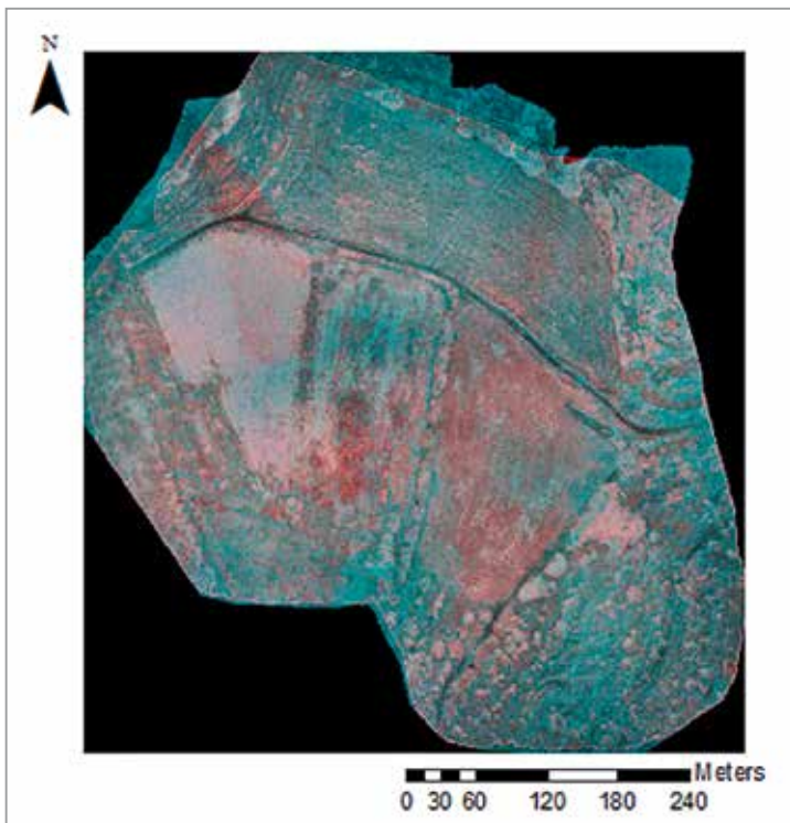
FIG. 152. Resultado del tratamiento digital de la imagen de Labitlosa VIS-NIR con un filtro High pass con una kernel de 5x5 (composición 431) con ajuste lineal de desviación estándar (2,5).
