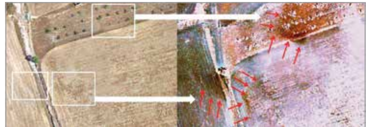
FIG. 165. Resultado del tratamiento digital de las imágenes (creación de neo-canales R: NDVI_6; G: NDVI_5; B: NDVI_4 y realce lineal del histograma con puntos de corte) para la identificación de los restos arqueológicos. Se puede observar claramente la diferencia entre la imagen del visible y la identificación de los restos arqueológicos gracias a la metodología utilizada.
