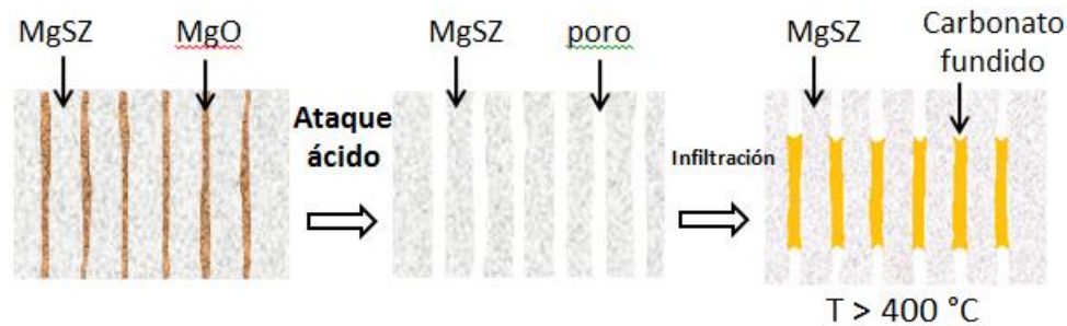
Figura 10. Representación esquemática de la fabricación de las membranas duales de este trabajo.
