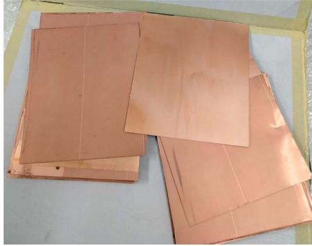
Figura 8.8: Circuitos testigo fabricados en paralelo a las nuevas Micromegas de TREX-DM y que fueron medidos con el germanio 'GeAnayet', del servicio de radiopureza del LSC, para cada proceso de limpieza realizado.
