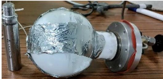
Figura 7.17: Fotografía del recipiente con polvo de Calcio durante las pruebas de irradiación.
