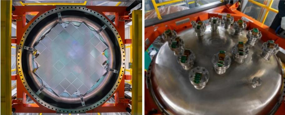
Figura 5.18: [35] Imágenes de conjunto del detector PandaX-III de 140 kg.
