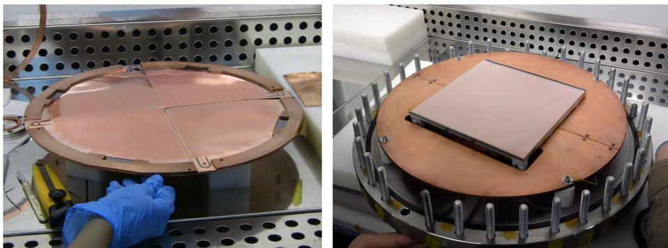
Figura 3.18: • Izquierda: plano de lectura desarrollado para el prototipo NEXT-MM, formado por cuatro Micromegas tipo microbulk [29]. • Derecha: módulo SR2M en su posición final después de algunas modificaciones de la TPC para su posicionamiento.
