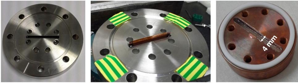
Figura 3.14: • Izquierda: Brida estándar DN63DF de acero inoxidable usada para la medida de fugas debido a la permeabilidad del epoxy. • Centro: Brida estándar DN63DF de acero inoxidable usada para la medida de fugas debido al circuito Micromegas más el epoxy. • Derecha: Brida de cobre con cuchilla usada durante las medidas de estanqueidad del sistema pasa-muros completo.
