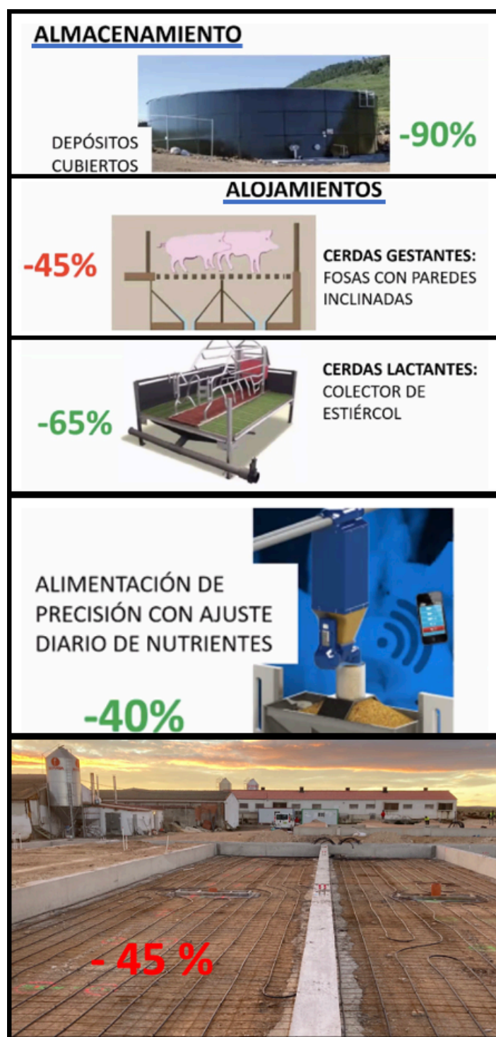
Fig. 3.29. Ejemplos de reducción de amoníaco en una granja que cumplen las MTDs ( Fuente: Seminario online de Emisiones Porcinas, 2021 )
