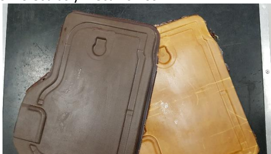
Figura 30. Demostradores de fibra de lino y fibras de PLA del respaldo de los asientos traseros de un Lancia Ypsilon, logo del proyecto.
