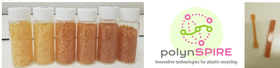
Figura 31. De izquierda a derecha. Pellets de PA-6 irradiados (100 KGy, 300 KGy y 500 KGy), logo del proyecto, probetas de tracción y flexión irradiadas a 300 KGy.
