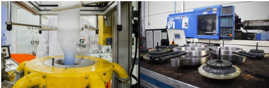
Figura 7. Izq. Producción de film termoplástico mediante procesos de extrusión soplado. [31]; Dch. Producción de piezas termoplásticas mediante procesos de inyección. [32]
