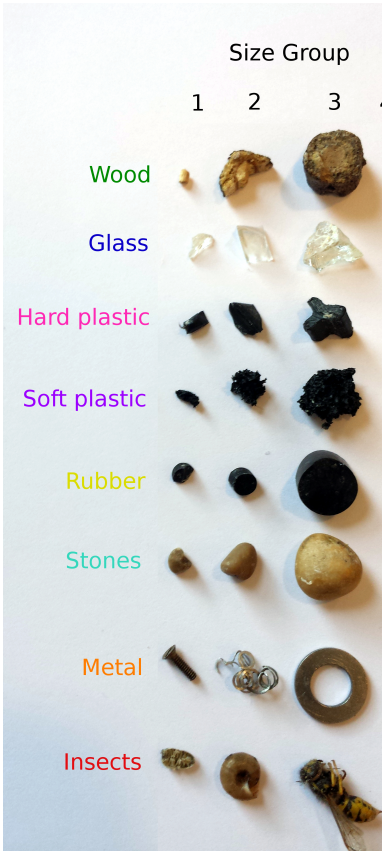
Figura 2.7: Objetos extraños seleccionados, con tamaños aproximados de 2x2x2, 3x3x3 y 4x4x4 mm, de izquierda a derecha.
