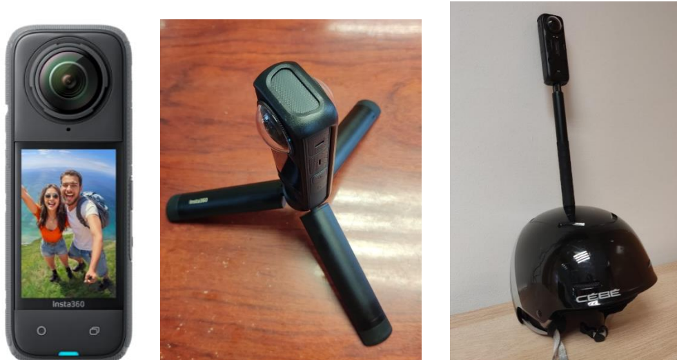
Ilustración 3. Medios para la digitalización de senderos. De izquierda a derecha: cámara insta 360 X4, cámara puesta en el trípode, cámara puesta en el casco con el selfie stick.
