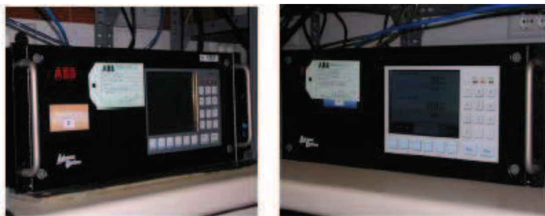
Figura A.15 Analizador IR de NO (izquierda) y analizador IR de CO/CO 2 (derecha).
