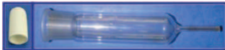
Figura A.13 Filtro (izquierda) y portafiltros (derecha).
