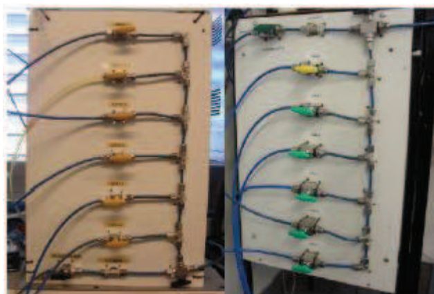
Figura A. 9 Panel de válvulas. Instalación de oxidación (izquierda) e instalación de formación de hollín (derecha).
