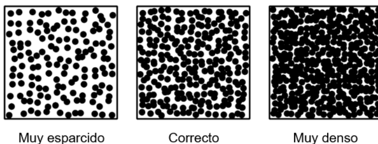
Ilustración 6. Representación de cómo debe ser un speckle correcto.
