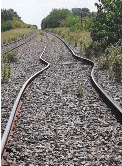
Ilustración 1. Vías de tren dobladas por la dilatación de los raíles.
