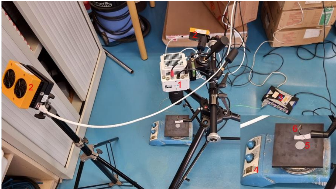
Ilustración 13. Configuración de la cámara de alta velocidad. Cámara de alta velocidad (1), focos (2), registrador (3), placa calefactora (4), probeta (5), termopar (6)
