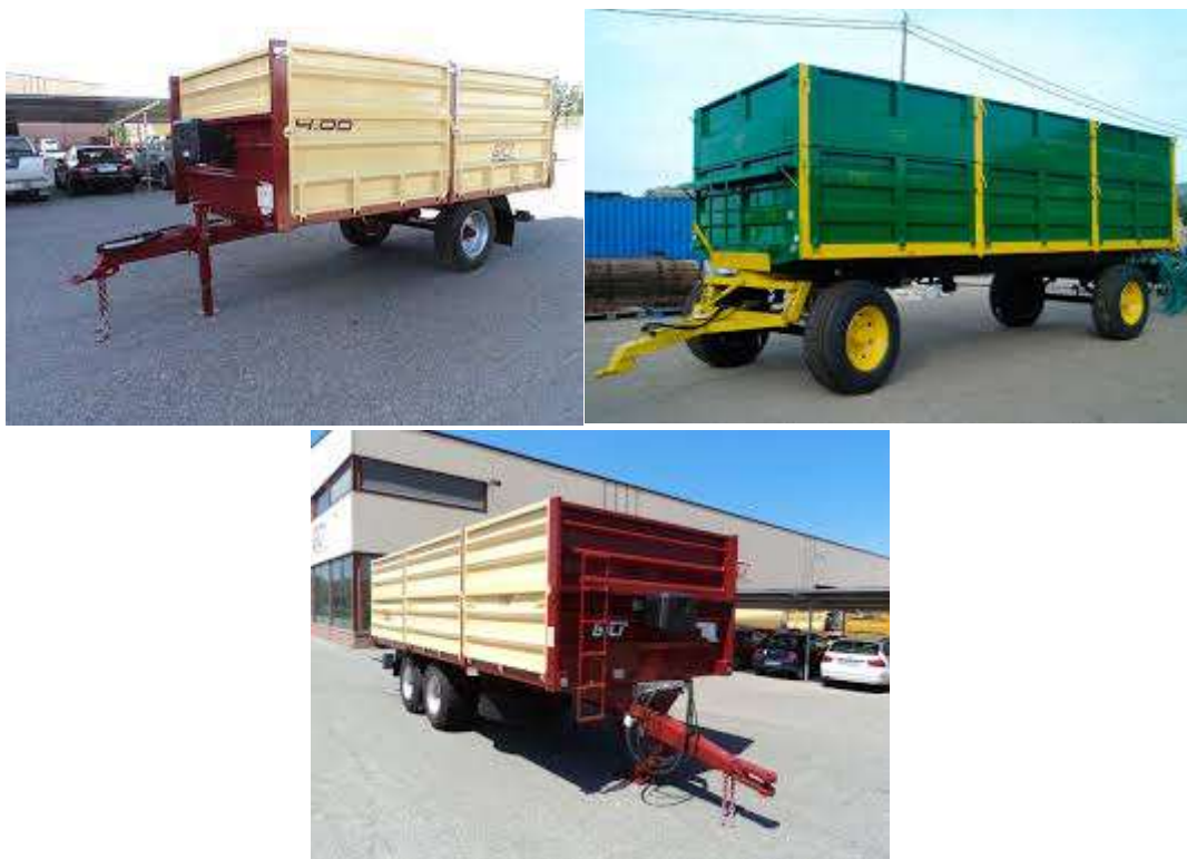
Ilustración 1. Remolque de 1 Eje (Superior Izquierda), Remolque de 2 Ejes Separados (Superior Derecha) y Remolque 2 Ejes Tándem (Inferior)
