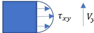
Ilustración 10. Tensión Tangencial debida a Cortante Caso Estático
