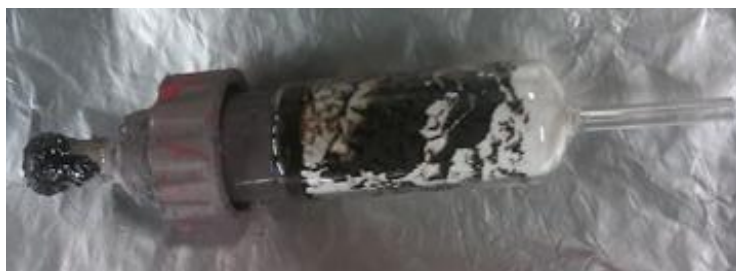
Figura 4.3. Fotografía del portafiltros tras un experimento de pirólisis a 950°C.
