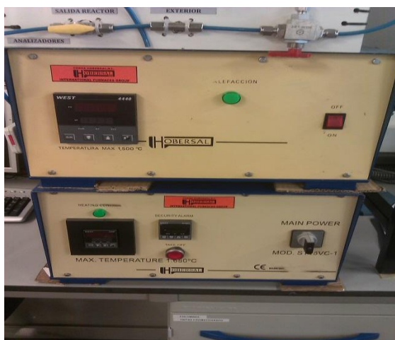
Figura B.9. Fotografía del sistema de control de temperatura del horno de la instalación de pirólisis.
