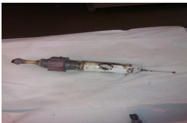
Figura B.10. Fotografía del portafiltros con el filtro tras un experimento de pirólisis.
