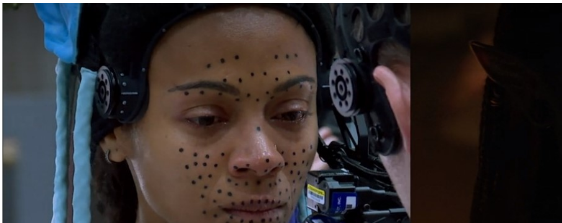
[Fig.14] Comparativa entre la actuación de Zoe Saldaña durante el rodaje de Avatar: The Way Of The Water (con el mejorado casco de dos cámaras de alta definición destinadas a la captación del rostro), y el resultado final traslado al Neytiri.
