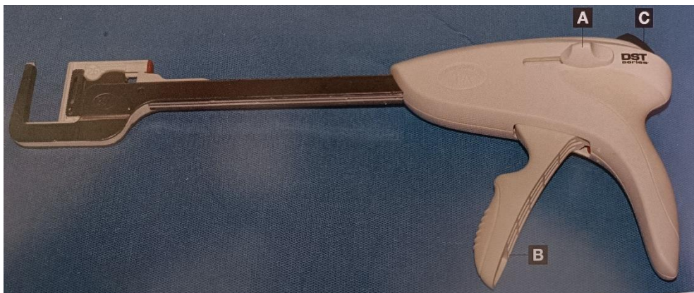
Figura 10: Grapadora quirúrgica vascular. Mando A para colocar el pistón que limita el movimiento del tejido, mando B para deslizar el cartucho con las grapas en el tejido y mando C para liberar el dispositivo y poder extraer la grapadora (Rodríguez et al., 2011)
