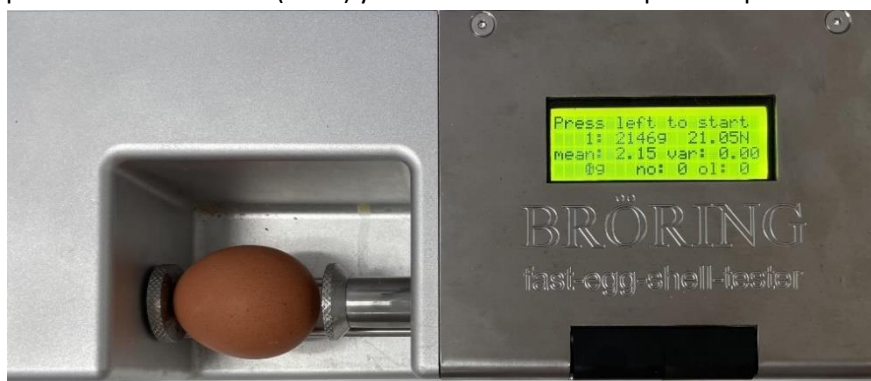
Figura 22: Aparato empleado para la medición de la resistencia de la cáscara: BRÖRING “Fast-Egg-Shell-Tester”.
