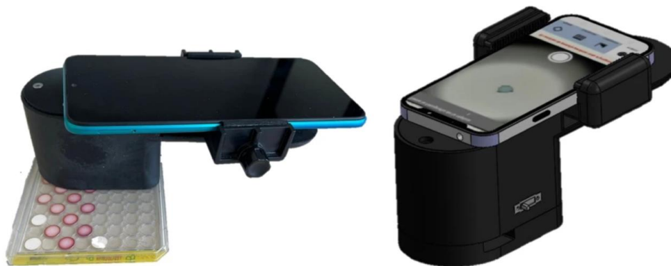
Figura 5. Móvil con caja de iluminación para la realización de las medidas de los soportes sólidos. (Domínguez et al., 2024).
