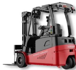
Ilustración 8. Ejemplo de AMR Carretilla (Fuente: VisionNav)
