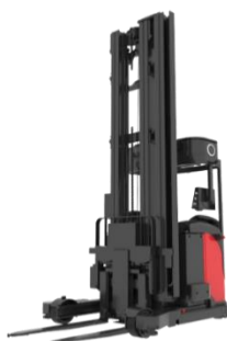
Ilustración 11. Ejemplo de AMR Retráctil (Fuente: VisionNav)
