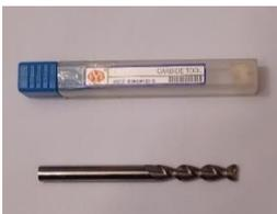
Imagen 6. Fresa punta plana, carburo (HRC 50) 8mm de diámetro, 40mm de corte, 100mm de longitud – 2 labios
