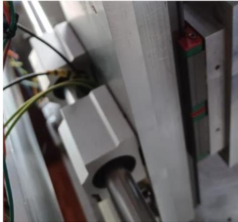
Imagen 12. Detalle de los rodamientos
