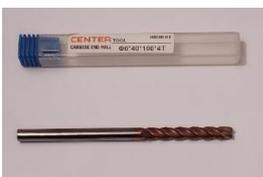
Imagen 7. Fresa punta plana, carburo 6mm de diámetro, 40mm de corte, 100mm de longitud -
