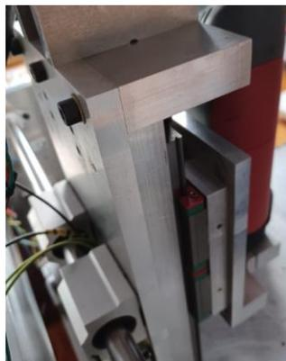
Imagen 13. Detalle de los rodamientos
