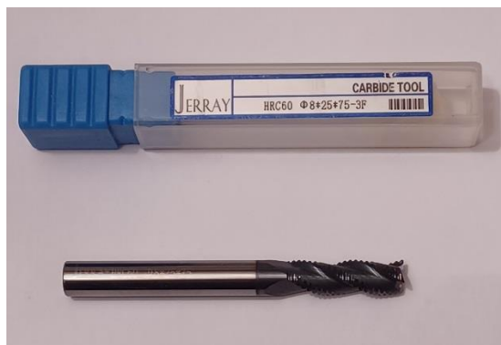
Imagen 22. Fresa punta plana de desbaste, carburo (HRC 60) 8mm de diámetro, 25mm de corte, 75mm de longitud -- 3 labios
