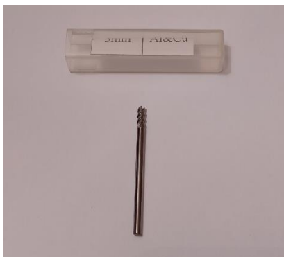
Imagen 21. Fresa punta plana, carburo (específica para aluminio – cobre) 3mm de diámetro, 6mm de corte, 50mm de longitud -- 2 labios
