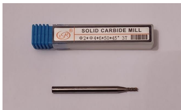
Imagen 23. Fresa punta plana, carburo Vástago 4mm de diámetro, corte de 2mm de diámetro, 6mm de corte, 50mm de longitud -- 3 labios
