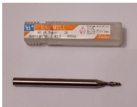
Imagen 15. Fresa punta de bola, acero rápido (HSS)
