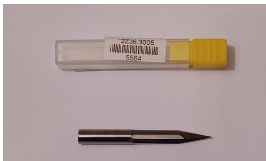
Imagen 24. Fresa punta cónica, carburo (HRC 60) 6mm de diámetro, 30° de corte, 0.5mm de punta -- 2 labios
