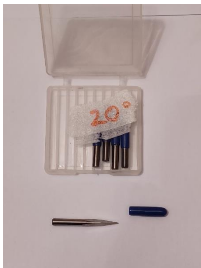
Imagen 25. Fresa punta cónica, carburo (HRC 60) 3.25mm de diámetro, 20° de corte, 0,1mm de punta, 30mm de longitud -- 1 labio
