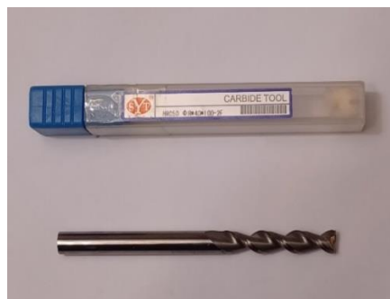
Imagen 16. Fresa punta plana, carburo (HRC 50)
