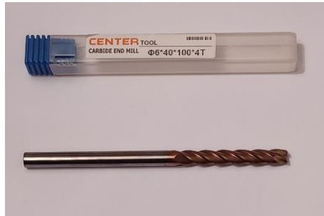
Imagen 18. Fresa punta plana, carburo
