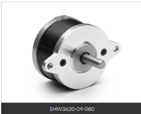
ILUSTRACIÓN 26 MOTOR QUE HACE GIRAR RUEDA SEPARADORA DE CHAPAS (MOTOR PASO A PASO 0,9° 90mNm 0,8A 36x36mm CABLE - TRANSMOTEC)
