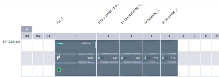
Figura 28 Control de dispositivos autómata programable
