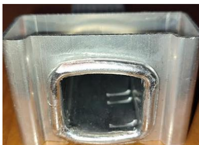
Figura 15 Resultado fallo total módulo de expandido
