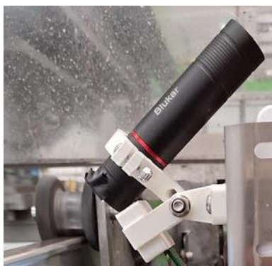
Figura 23 Foco de luz de la cámara superior
