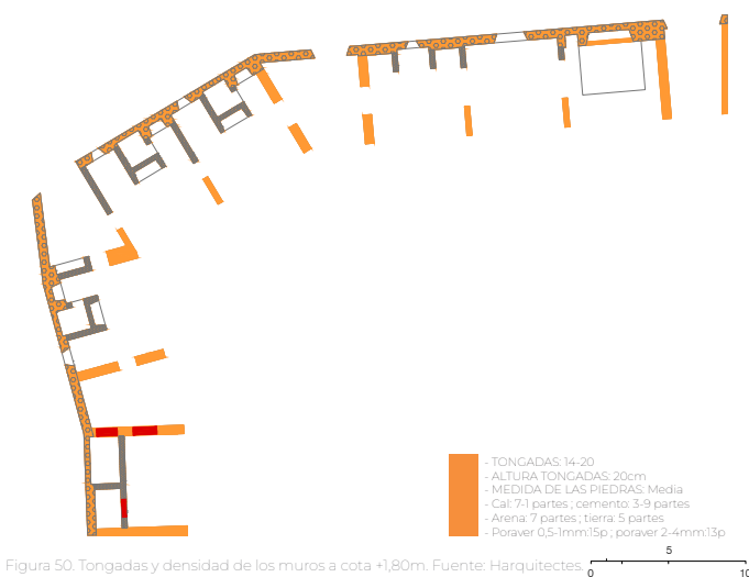
Figura 50. Tongadas y densidad de los muros a cota +1,80m. Fuente: Harquitectes.
