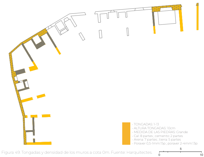
Figura 49. Tongadas y densidad de los muros a cota 0m. Fuente: Harquitectes.
