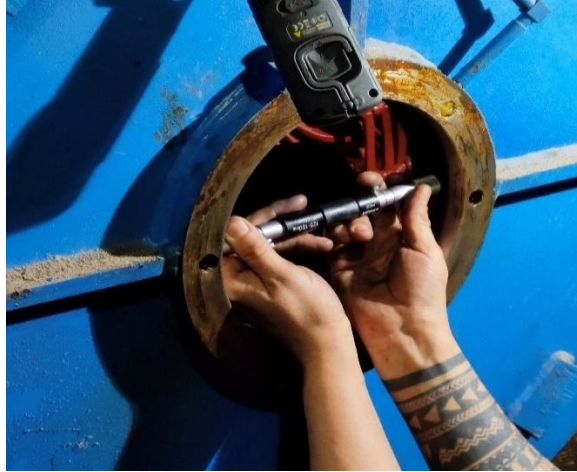
Figura 15. Medición de diámetro del alojamiento del rodamiento
