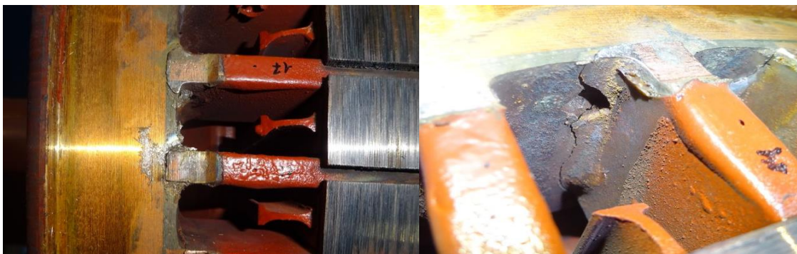
Figura 17. Fotografías de las barras rotas del rotor.
