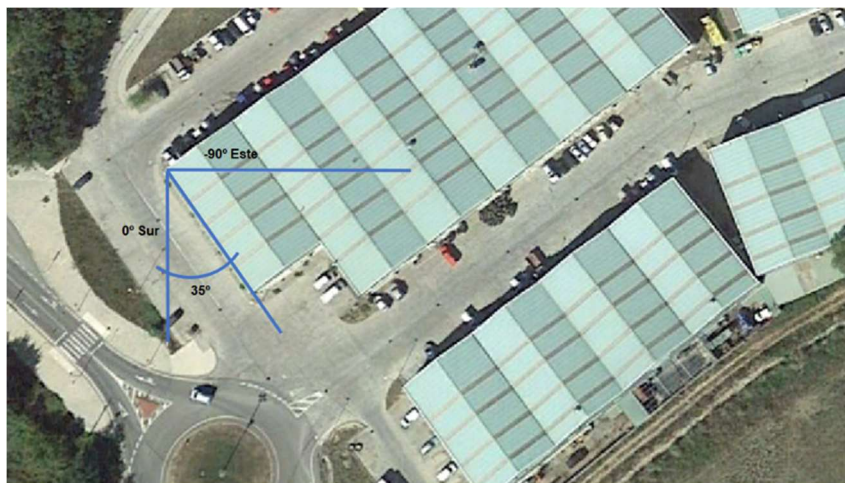
Ilustración 11. Cálculo del Azimut de las cubiertas EC_1 y EC_2. [Fuente: Google Earth Pro]
