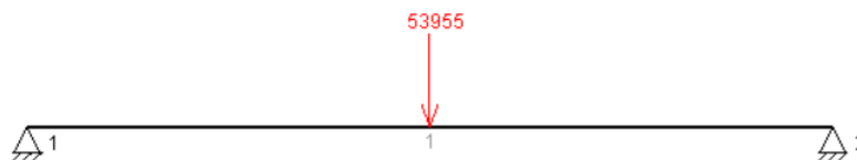
Figura B. 24. Viga móvil biapoyada con carga puntual del carro
