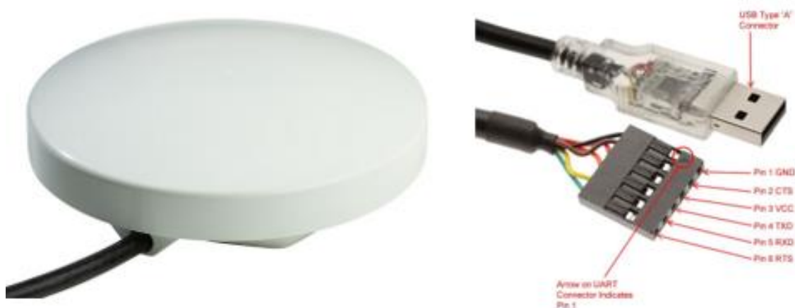
Figura 7. Módulo ROCKBLOCK+ y pinout USB
