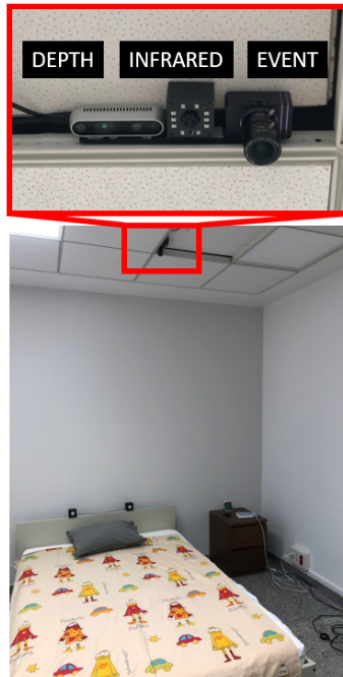
Figura 1.2: Se muestra la habitación utilizada para grabar el conjunto de datos que imita una habitación con una cama doble. Colocamos tres cámaras diferentes (Eventos, Profundidad e Infrarrojos) en el techo, justo encima de la cama.
