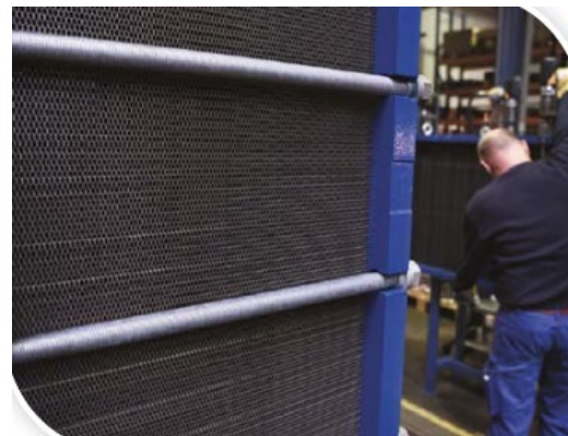
Ilustración 10. Detalles de Pernos y Placas en un Intercambiador de Calor de Placas
