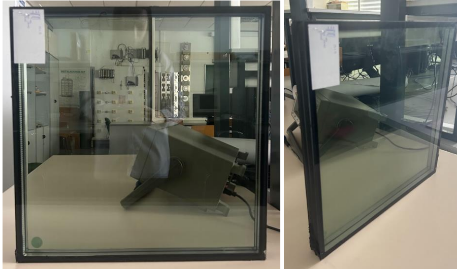
Figura 5.11. Ventanas con dos FSS de 15mm cada una.
