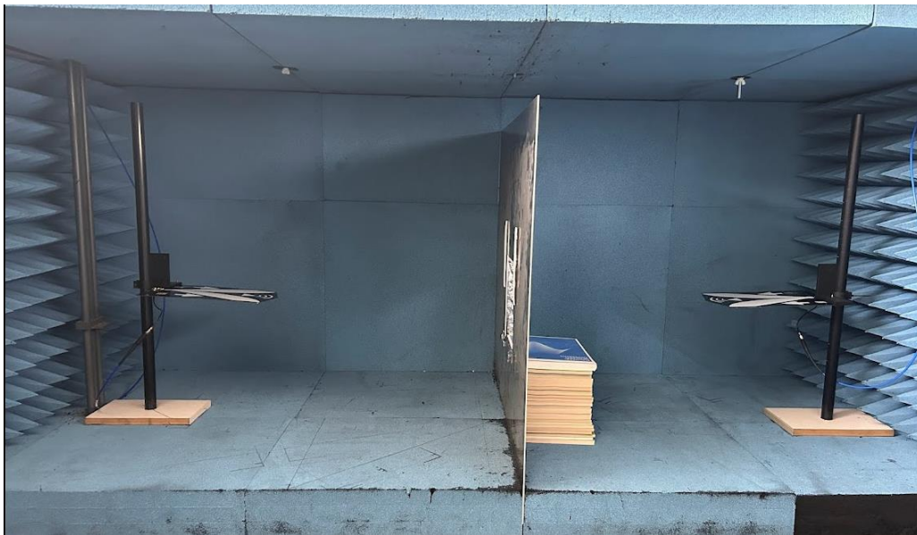
Figura 5.1. Montaje dentro de la cámara anecoica
