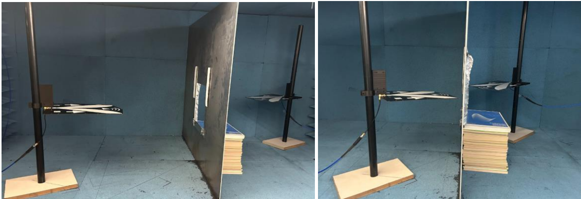
Figura 5.6. Antenas posicionadas a 22.5^\circ y 45^\circ
