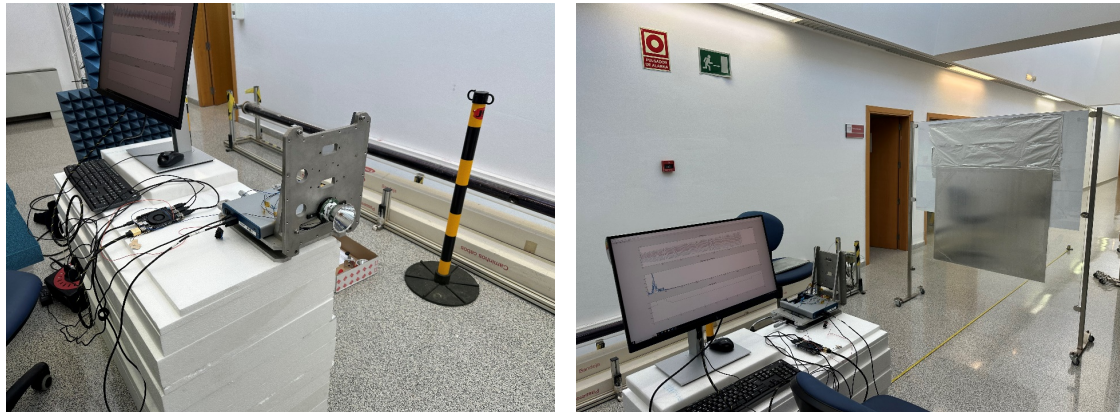
Figura 4.14: Montaje realizado para la comprobación de las medidas de distancia del radar FMCW
