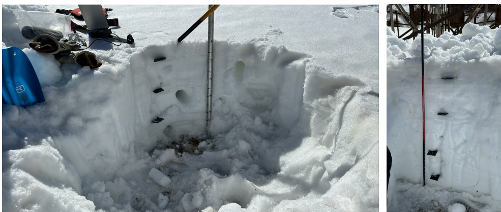
Figura 1.1: Muestra la realización de una cata del manto nivoso aplicando una sonda nivométrica
