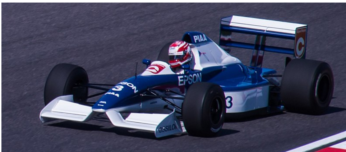
Figura 2.2: Modelo de nariz elevada en el Fórmula 1 019 introducida por Tyrrell.
