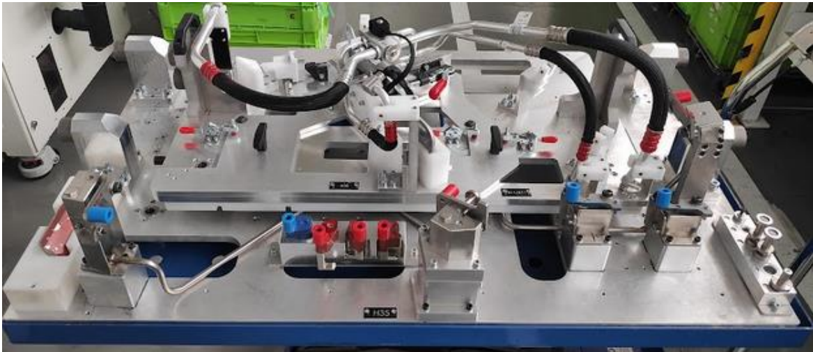
Imagen 3.1.9 Módulo 4 sobre paleta de montaje y paleta de helio
