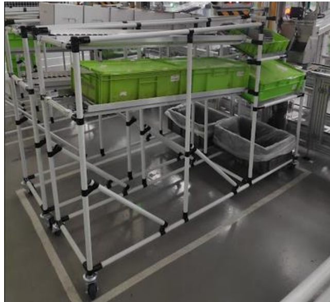
Imagen 4.3.1 Racks de suministro de componentes
