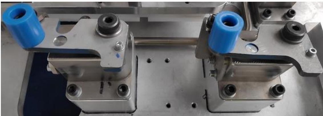
Imagen 8.3.4 Pestillos de sujeción con casquillos instalados
