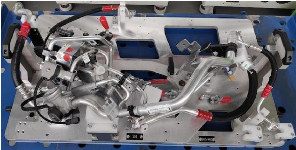
Imagen 3.1.3 Módulo 3 montado sobre paleta de montaje
