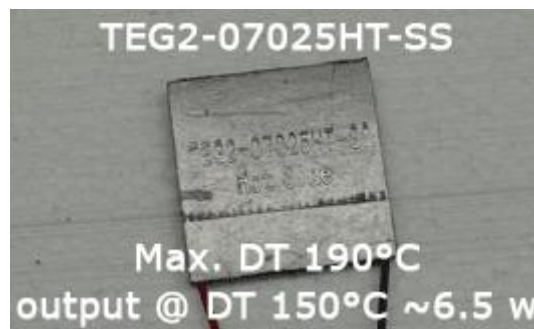
Figura 17: Modelo de TEG utilizado.
