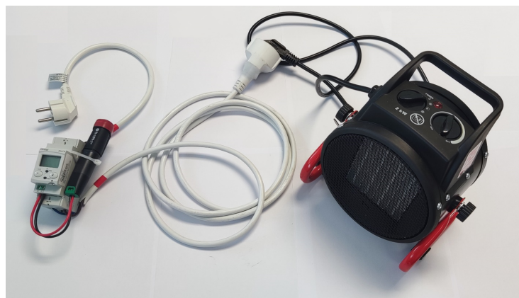
Figura 2.4: Montaje de una de las etapas de entrada de potencia.
