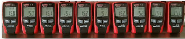
Figura 2.3: Comprobación de la calibración de los sensores de temperatura utilizados en la experimentación.
