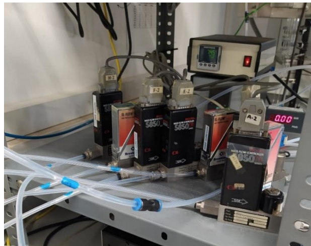
Figura 6. Controladores de caudal de los gases que mantienen los caudales constantes.
