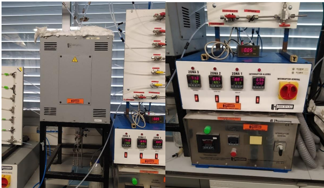
Figura 10. Horno eléctrico utilizado para calentar el reactor.
