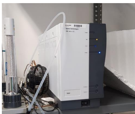
Figura 15. Cromatógrafo utilizado para analizar la composición de los gases a la salida del reactor
