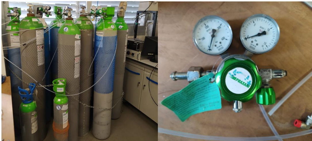
Figura 3. Botellas de gas a presión que constituyen la alimentación al reactor
