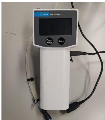
Figura 14. Medidor de caudal automático empleado para medir los caudales reales de los gases
