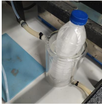
Figura 9. Condensador para condensar el vapor de agua generado en el reactor.
