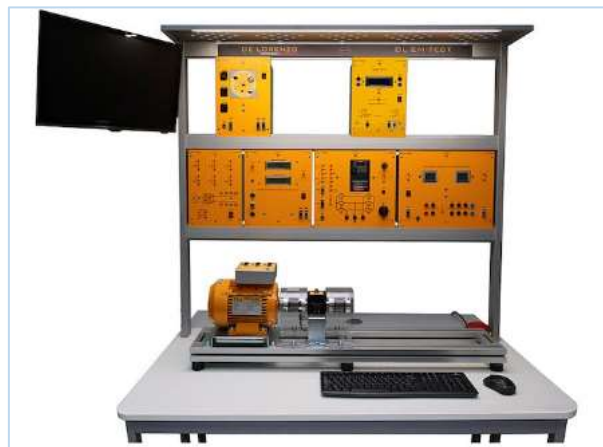
Figura 1. Banco de ensayos, fabricante: “De Lorenzo”
