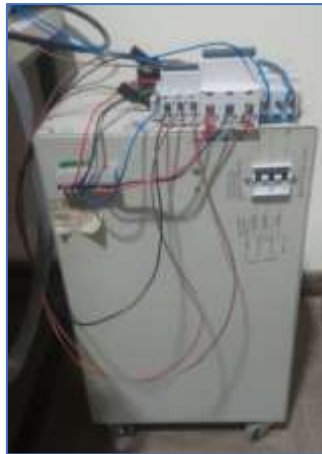
Figura 4. Autotransformador disponible en el laboratorio de máquinas eléctricas.
