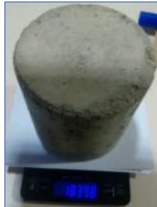
Figura 26. Cilindro de hormigón, peso 1839,8 gramos
