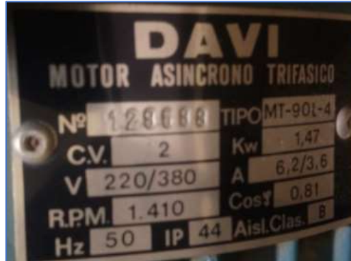
Figura 6. Placa de características del motor utilizado
