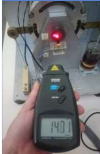
Figura 29. Velocidad del motor trabajando en vacío 1471 rpm
