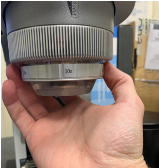
Figura 16. Enroscado y desenroscado de la lente.
