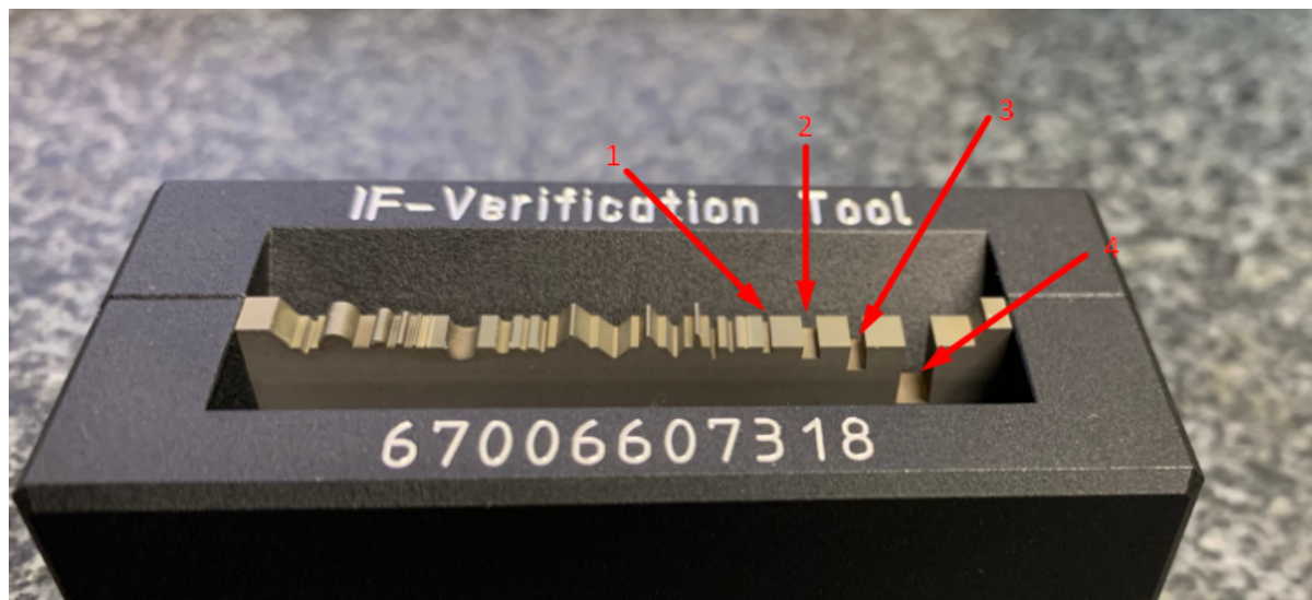
Figura 6. Escalones del patrón IF-Verification Tool a medir en la repetibilidad del operario en el eje Z.
