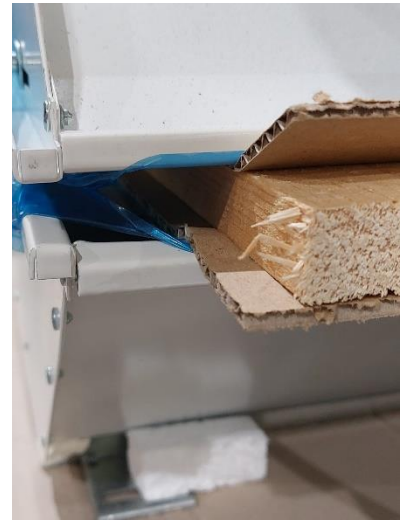
Ilustración 34. Desajuste del frontal
