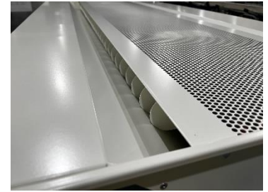
Ilustración 30. Roce entre deflectores y chapa de toberas
