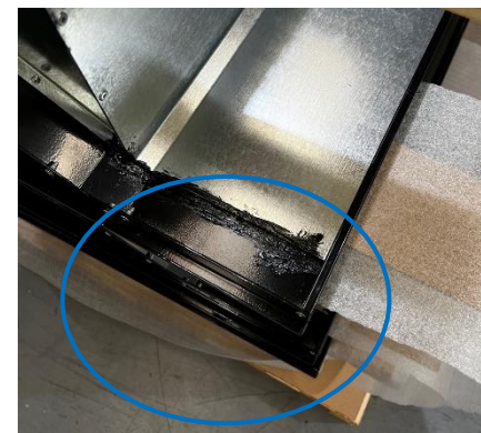
Ilustración 31. Silicona sin secar DID632 especial
