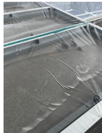
Ilustración 55. Resistencia al agua nueva lámina polietileno
