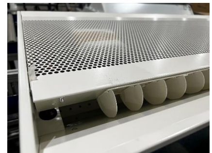
Ilustración 50. Correcta separación batería/frontal
