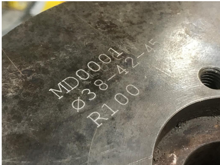
Figura 7. Resultado final del proceso de grabado
