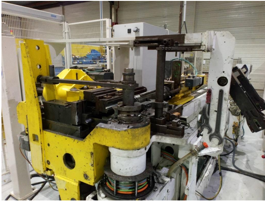
Figura 41: Curvadora 6. A la derecha (en negro), el cargador lateral de tubos
