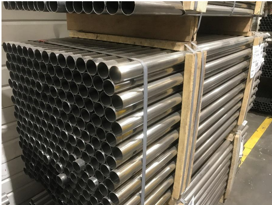
Figura 25. Tubos rectos utilizados como materia prima
