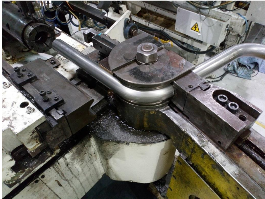
Figura 53. Seguidor principal a la izquierda. Seguidor de presión a la derecha
