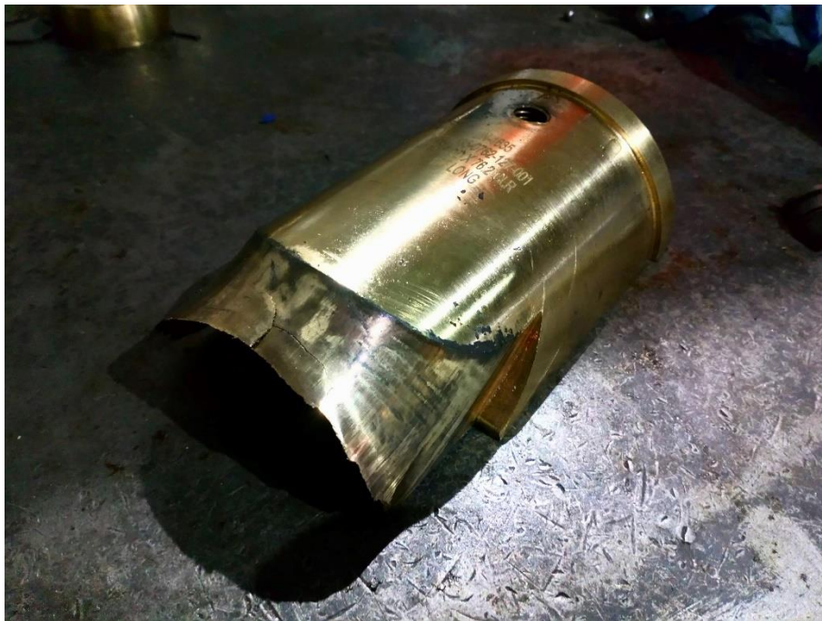
Figura 44. Wiper tras curvado de tubo
