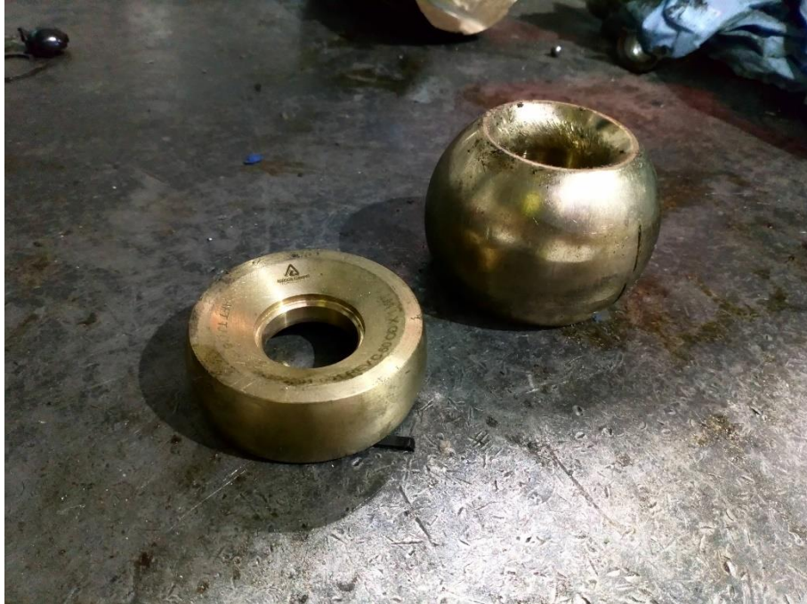
Figura 45. Distintos tamaños de bola para diámetros diferentes
