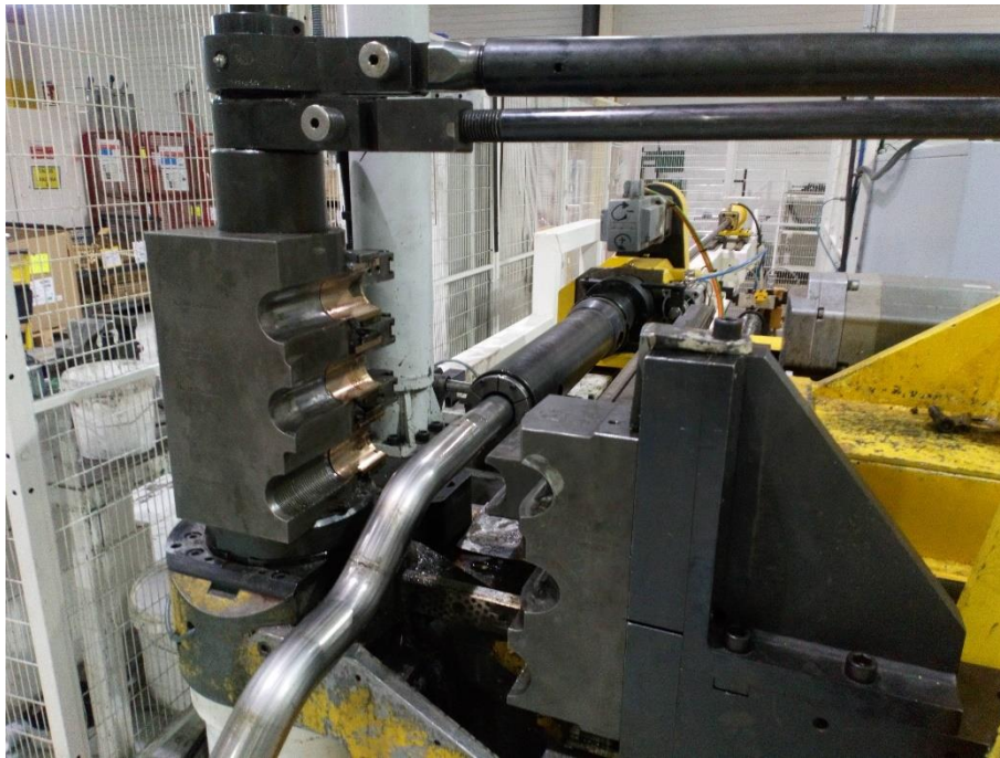
Figura 37. Vista en detalle de multistack colocado en la curvadora 3
