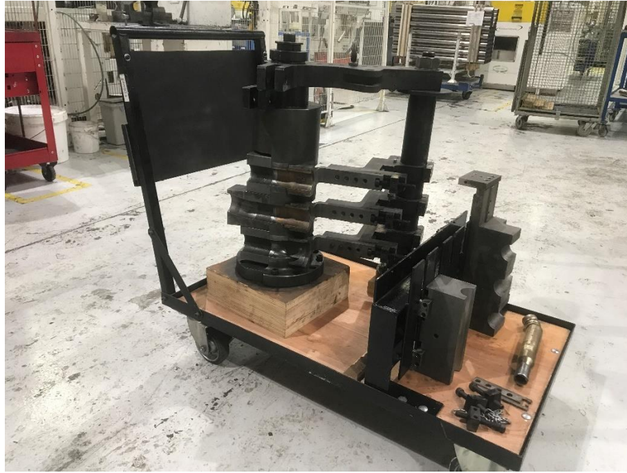
Figura 56. Multistack de curvado colocado sobre su carro
