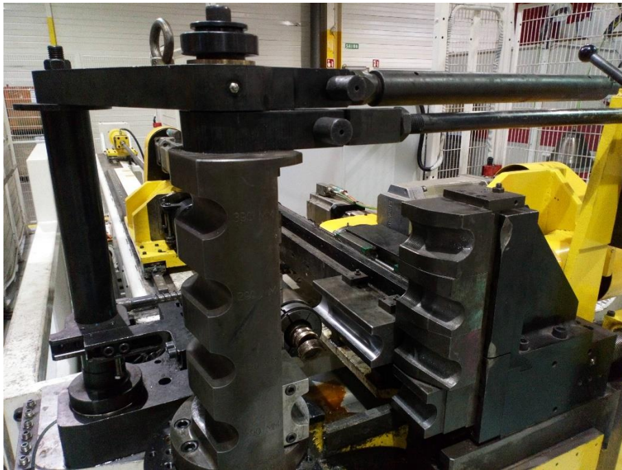
Figura 33. Vista detalla de los utillajes en la curvadora 1
