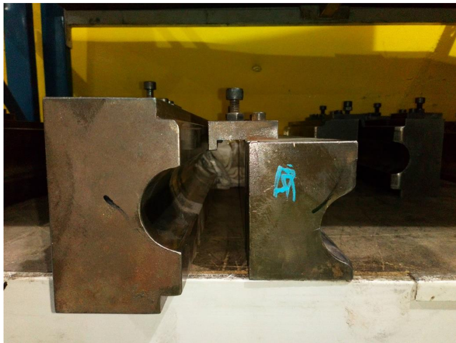
Figura 54. Seguidores de encaje e intercambiable a izquierda y derecha respectivamente
