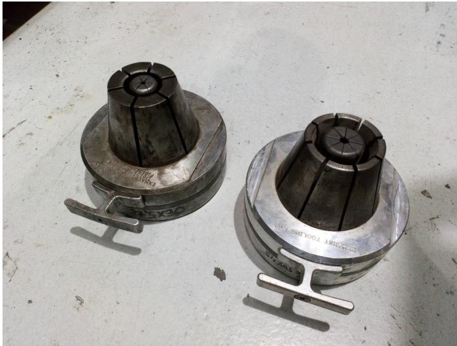
Figura 59. Utillajes I/O de calibre con distintos diámetros de tubo
