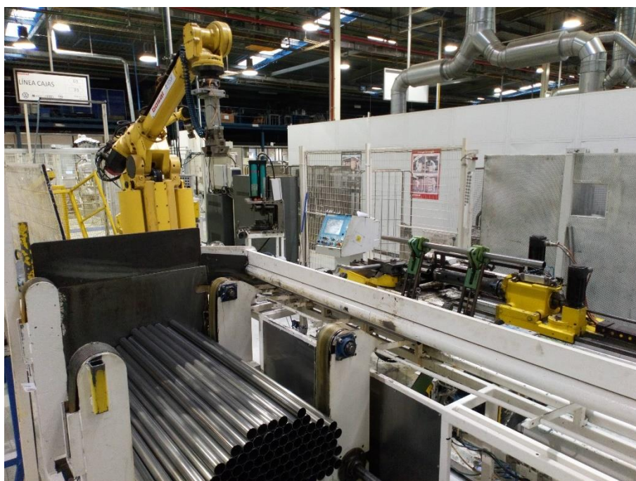
Figura 34. Bandeja de carga y brazo robótico en la curvadora 2
