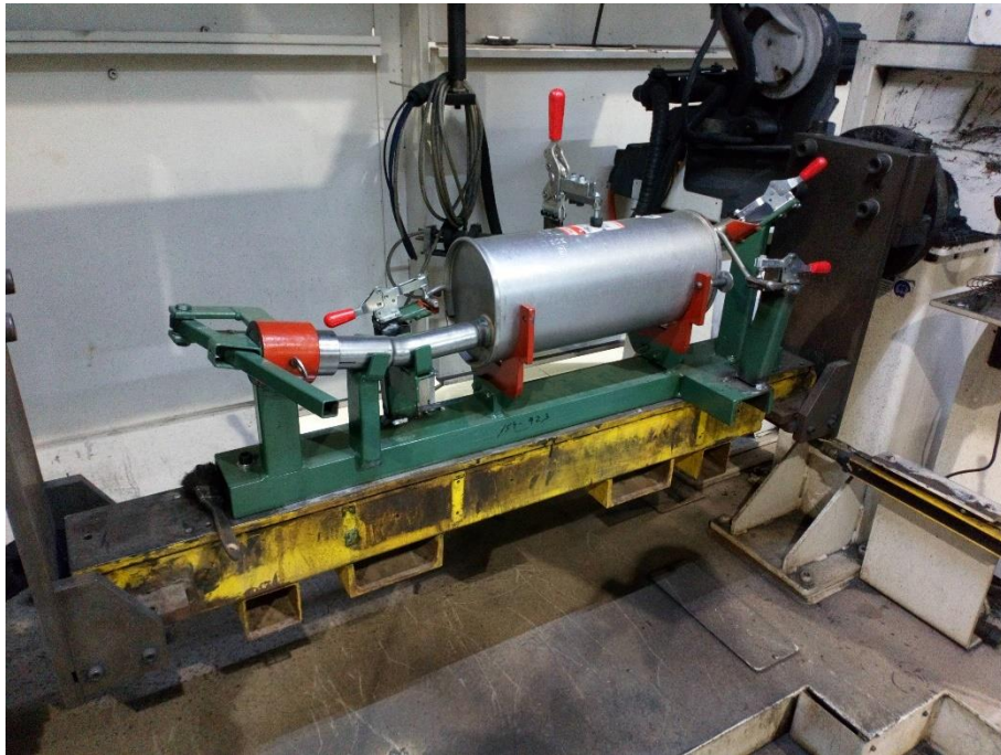
Figura 65. Colocación de partes a soldar
