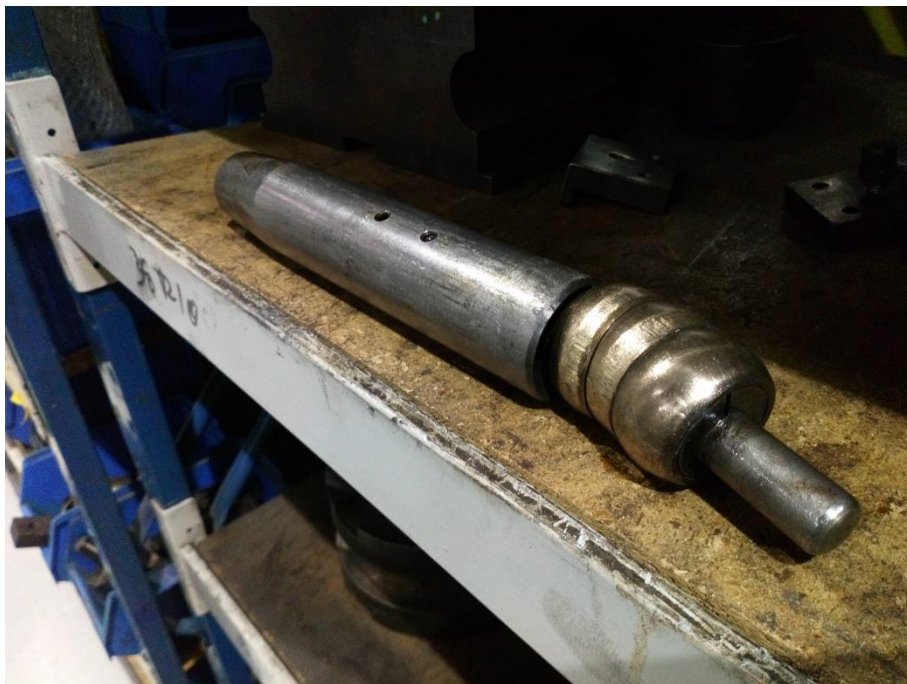
Figura 50. Mandril de bolas con sirga
