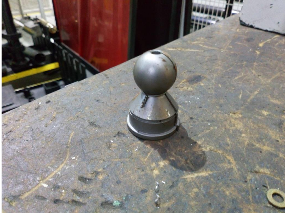
Figura 47. Peón listo para ser colocado en el interior del mandril
