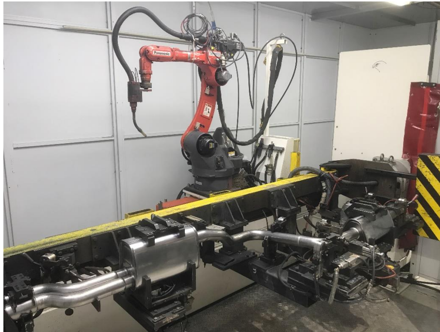
Figura 29. Cabina de soldadura con pieza lista para soldar
