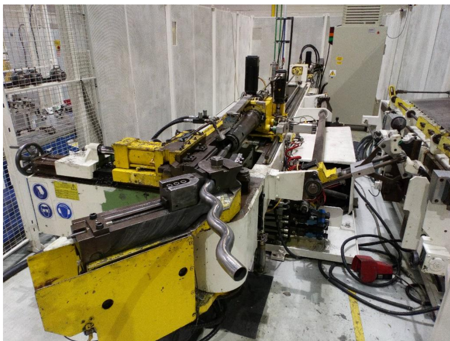
Figura 38. Vista frontal de la curvadora 4 en proceso de curvado
