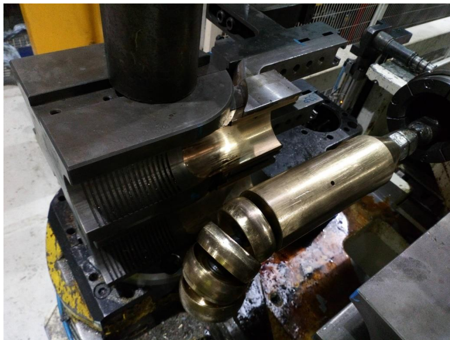
Figura 52. Posición de zapata y wiper en la curvadora
