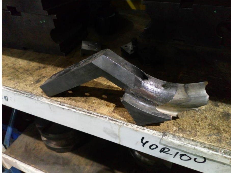
Figura 51. Zapata retirada de curvadora por wiper desgastado
