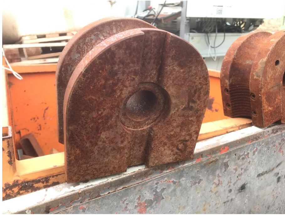
Figura 16. Estado de las matrices de curvado almacenadas en el exterior
