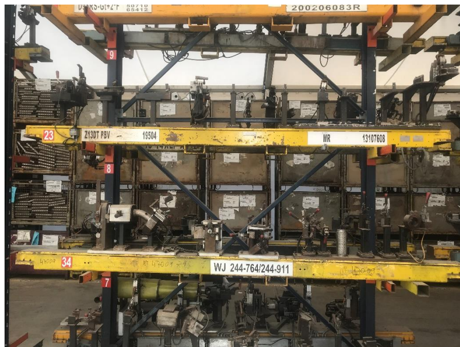
Figura 12. Número de utillaje en placa roja y referencias fabricadas en blanco
