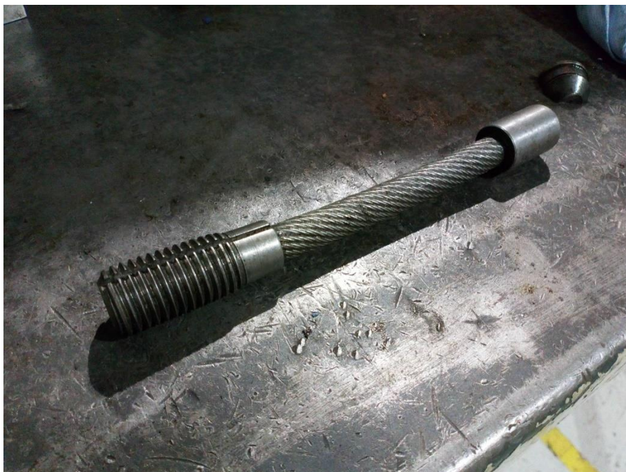
Figura 48. Sirga extraída del interior del mandril
