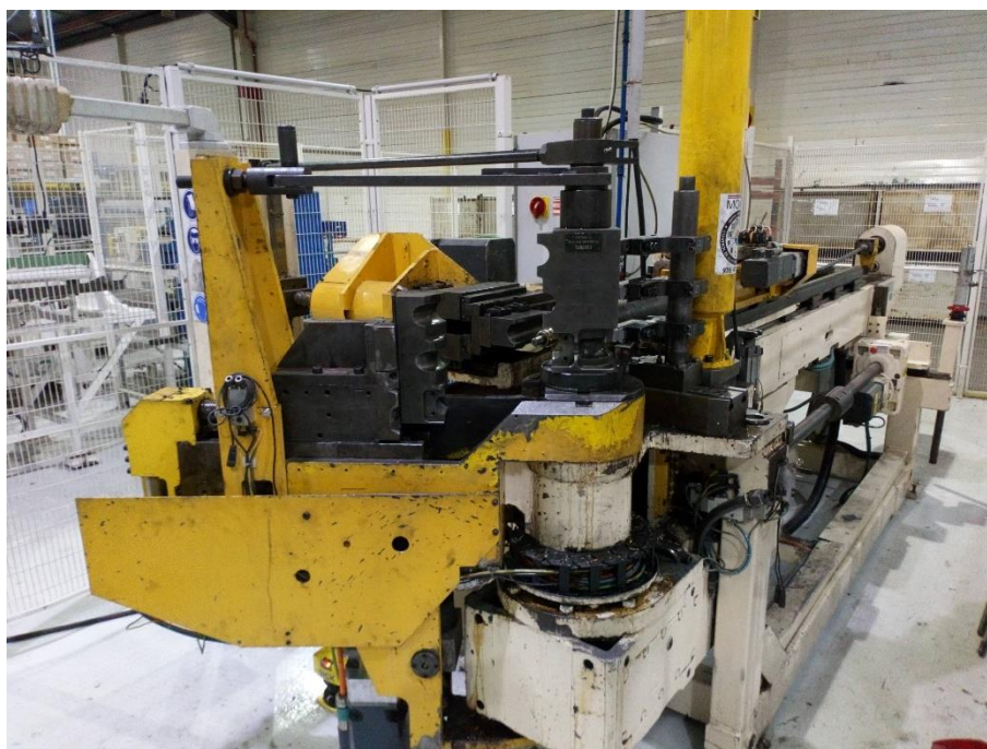
Figura 43. Curvadora 7 con multistack triple
