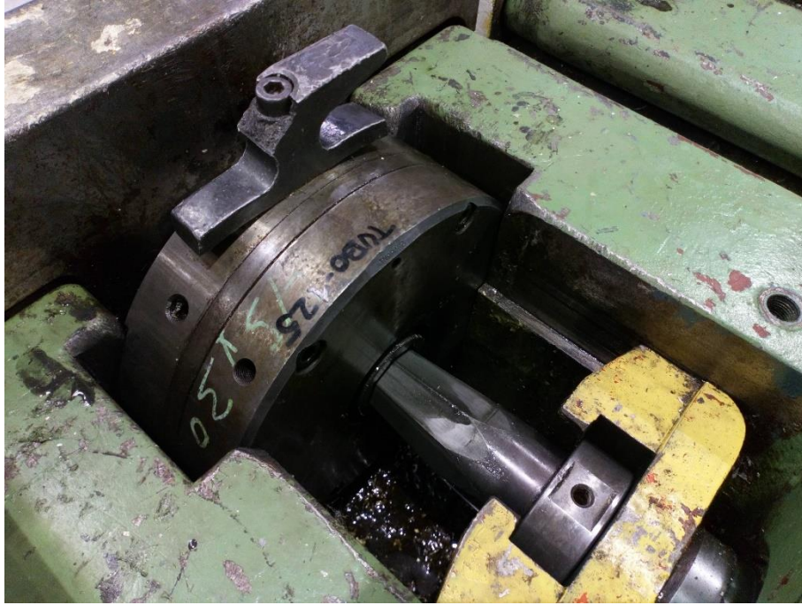
Figura 61. Colocación de utillajes en el interior de la calibradora
