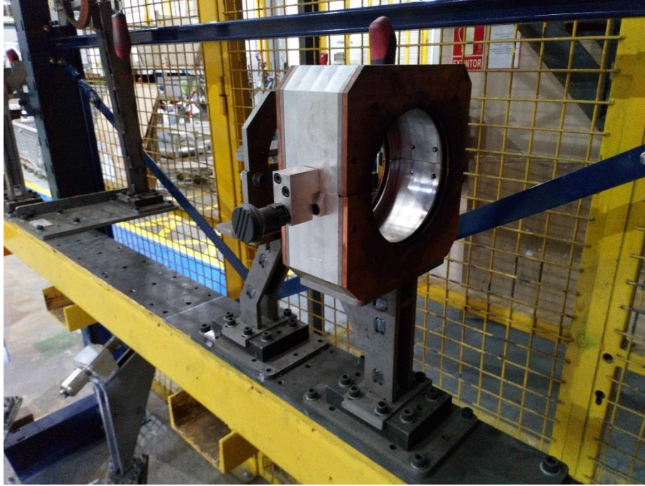
Figura 64. Detalle del sistema de utillajes modulares
