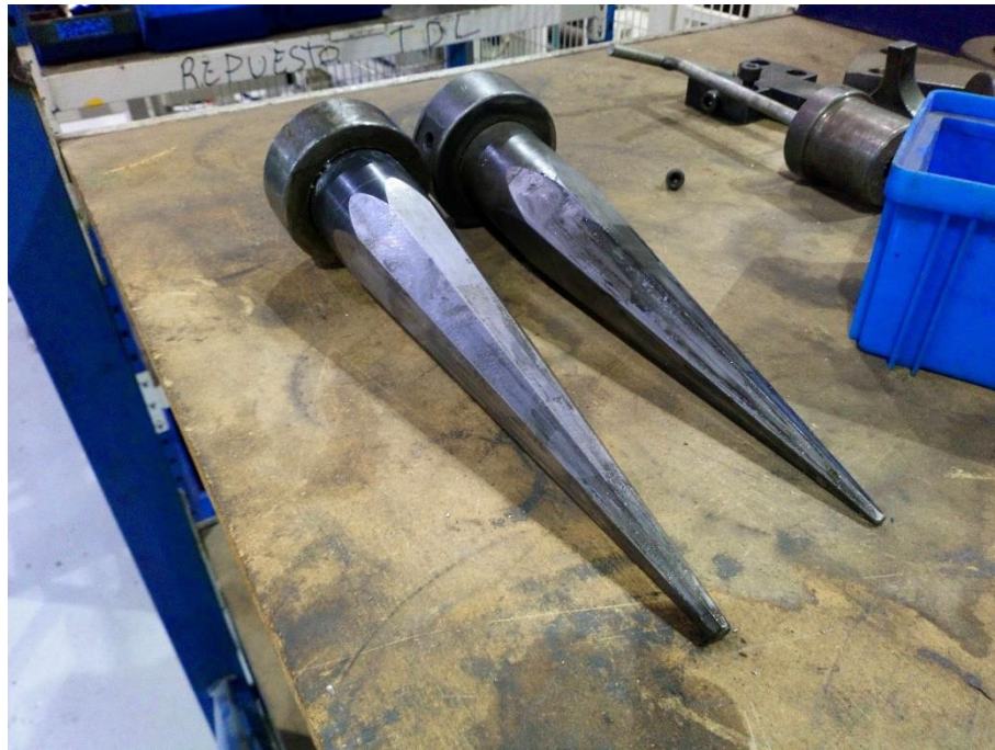
Figura 58. Punzones de ocho y seis caras, de izquierda a derecha
