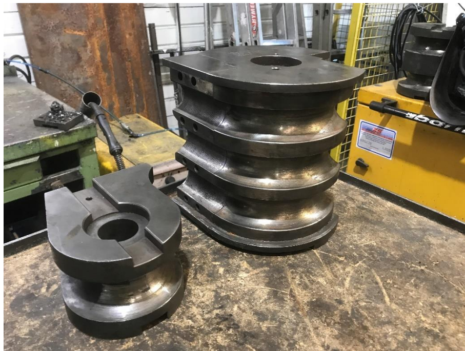
Figura 55. Comparación entre matriz simple y stack de curvado
