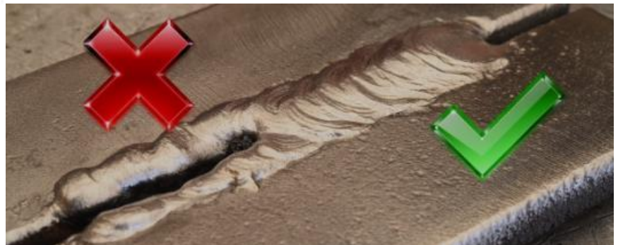
Figura 3.1 - (a) Esquema de uniones soldadas [4] (b) Imperfecciones de un cordón de soldadura
