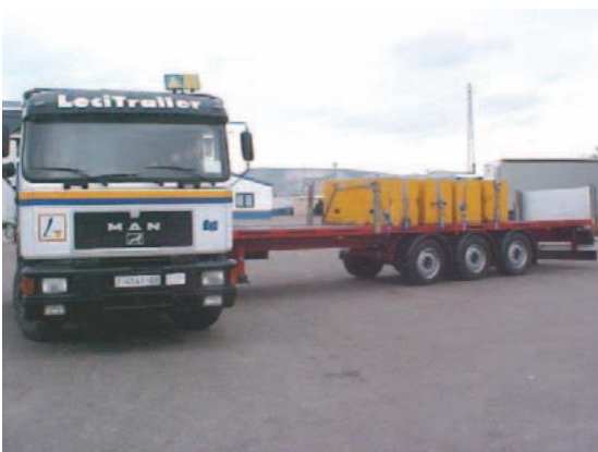
Figura 4.1- Posición del tractor-semirremolque considerada en la "maniobra de radio mínimo" [7]
