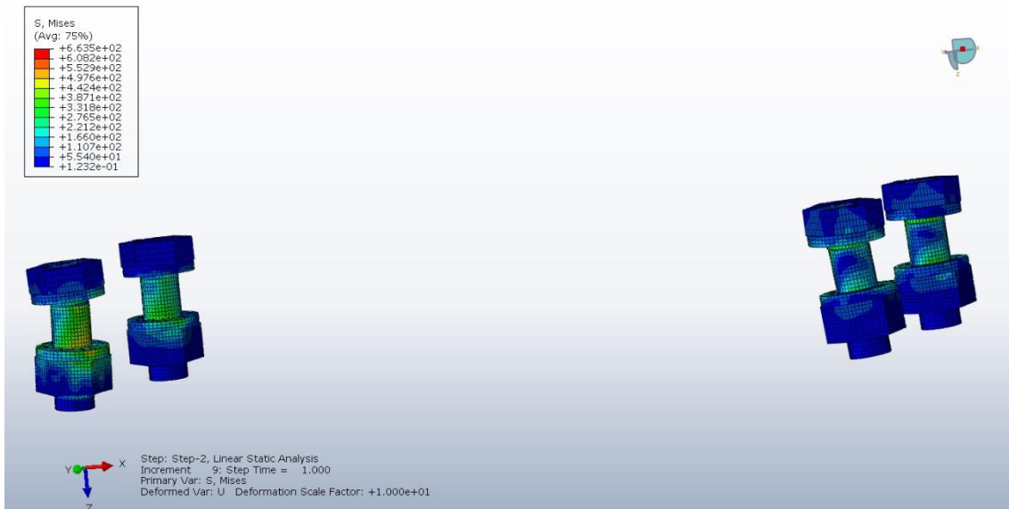
Figura 9.18 - Comportamiento de la unión atornillada si magnificamos 10 veces
