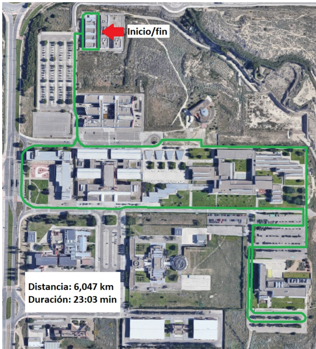
Figura 5.7: Recorrido realizado para el ensayo 3 Se atraviesan zonas rápidas y lentas, rectas y con curvas, para simular lo más fielmente un recorrido real. Se efectúan dos vueltas al mismo.
