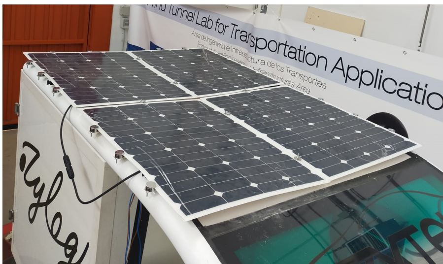
Figura 3.7: Paneles solares instalados en el Zylog. Se instalan en serie-paralelo para adecuarlos a la tensión admitida por el cargador solar.
