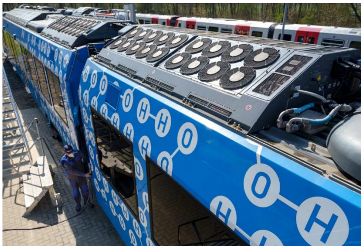
Figura 14: Alstom Coradia iLint, pilas de H 2 .
