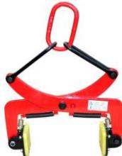
Por lo tanto, el problema que tenemos con este tipo de unión es que no hay nada diseñado específicamente para esto, por lo que se tendría que diseñar un enganche para poder coger las pinzas elevadoras para electrodomésticos con un polipasto o una grúa.
