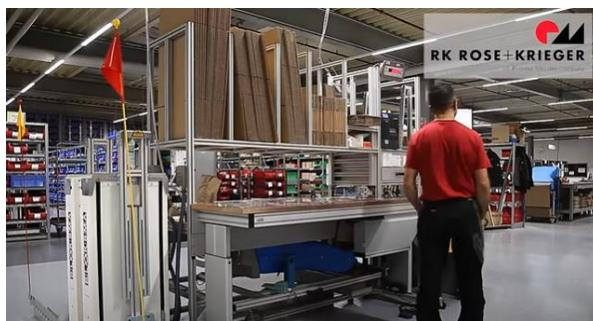
De esta mesa podemos sacar que es una mesa la cual se puede regular en altura mediante un mando que tiene en la parte inferior.
