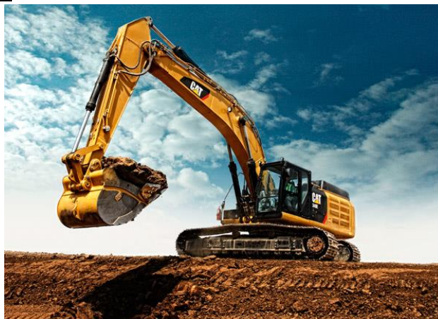
Imagen 1 Retroexcavadora con pluma monobloque
