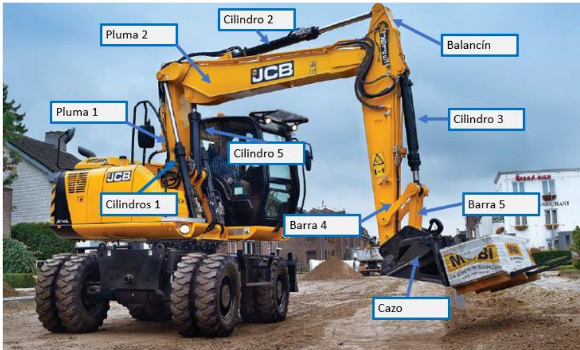
Imagen 6 Designación de componentes de retroexcavadora con pluma articulada
