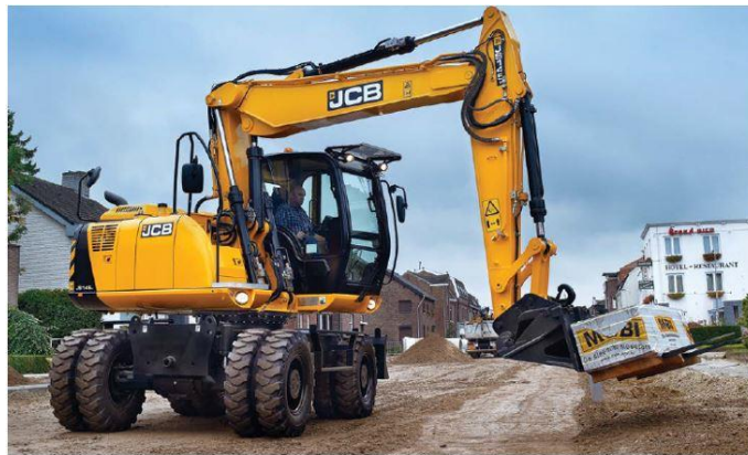
Imagen 2 Retroexcavadora con pluma articulada
