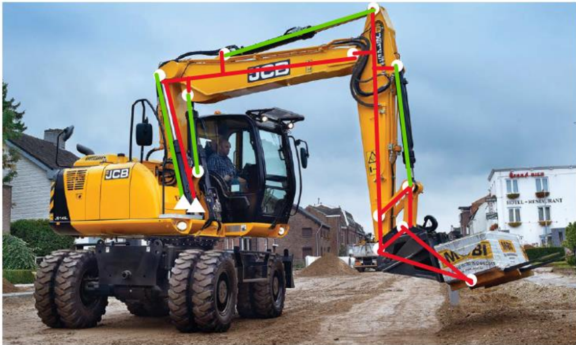
Imagen 8 Representación del modelo simplificado sobre una imagen real del conjunto.
